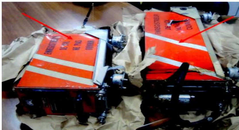
Slika 7. Snimač podataka o letu i snimač zvuka u kokpitu (Ministarstvo prometa i komunikacija Bosne i Hercegovine, Komisija za istraživanje nesreće, 2004.)
