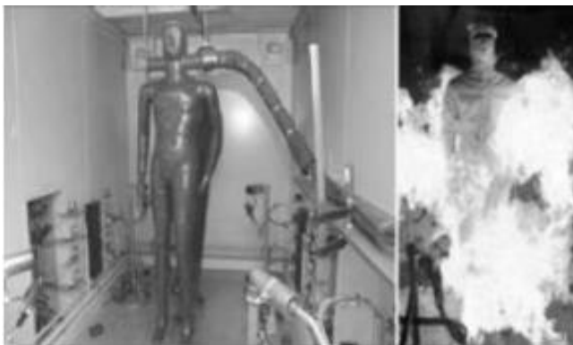
Slika 6. Požarna lutka (thermo-maneken) (Hursa Šajatović, Zavec Pavlinić, Dragičević; 2013)
