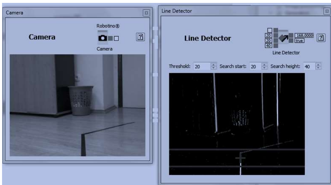
Slika 6. Prikaz detektirane trake na podu (RobotinoView model)
